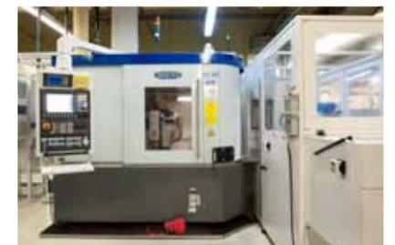
**Wälzschleifen von Außenverzahnungen an Wellen und Rädern:**
